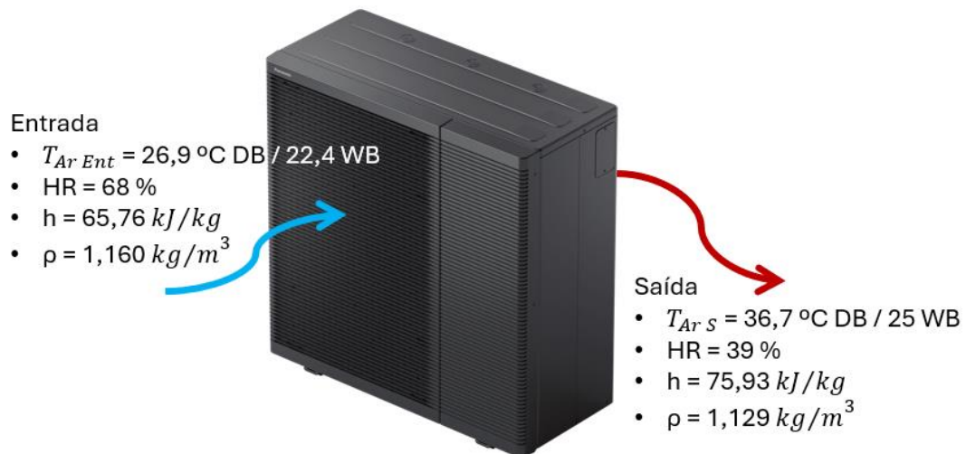
Figura 4.18 - Condições da temperatura do ar antes e após a passagem pelo permutador de calor na unidade exterior no modo arrefecimento, Agosto, Lisboa – Adaptado de [83].
