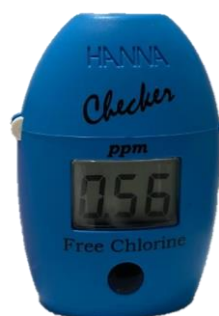
Figura 3.4. Fotómetro portátil utilizado para medição da concentração do cloro residual livre.
