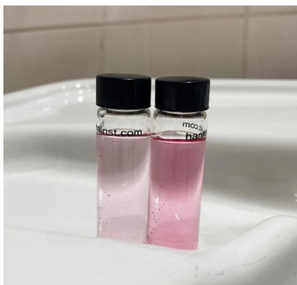
Figura 3.5. Células para o fotómetro com cloração rosa proporcional à concentração de cloro residual livre.
