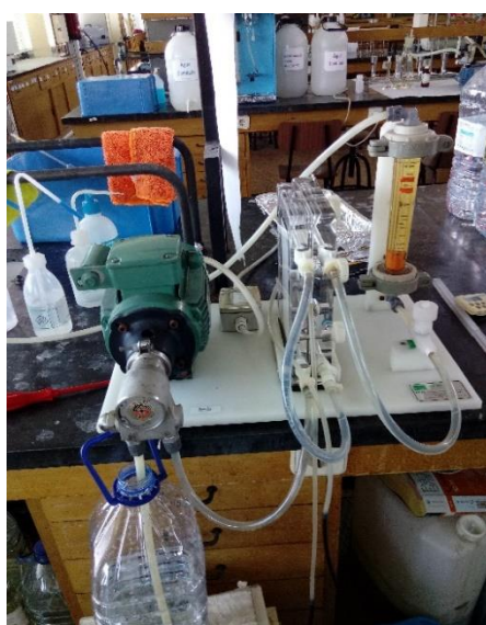
Figura 2.1. Instalação de ultrafiltração (UF) do ISEL: instalação real de UF (esquerda) e esquema da instalação de UF (direita) adaptado de (125).
