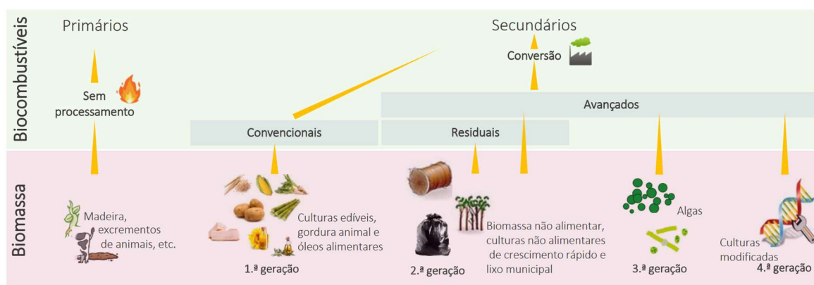
Figura 1 - Classificação de biocombustíveis de acordo com a matéria-prima (Production of liquid biofuels from renewable resources, adaptado por [7]).
