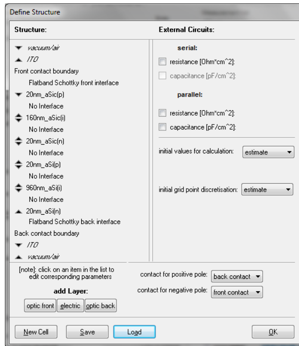
Figura 27 – Configuração da estrutura dos semicondutores a-SiC:H/a-Si:H empilhados.
