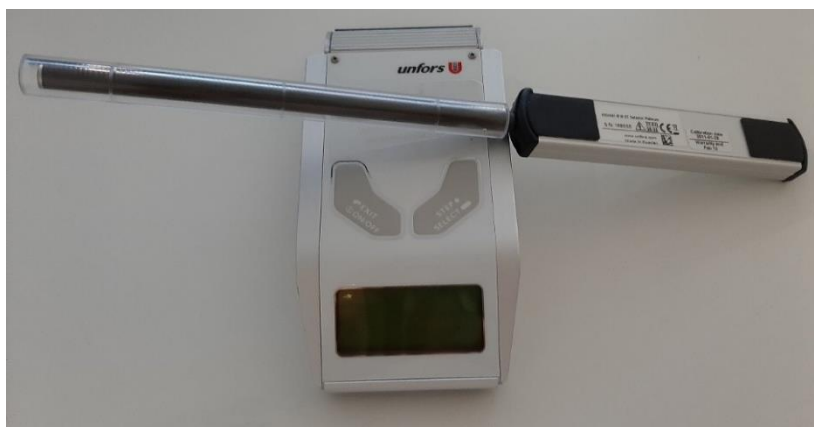
Figura 3.2 - Câmara de ionização da RaySafe Solo™ , presente no IPO de Lisboa (cortesia do IPOLFG)
