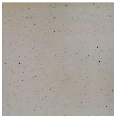
Figura 3-17. Membrana CA 22-0,5 \text{Fe}_3\text{O}_4 onde é possível ver as NPs incorporadas a olho nu.
