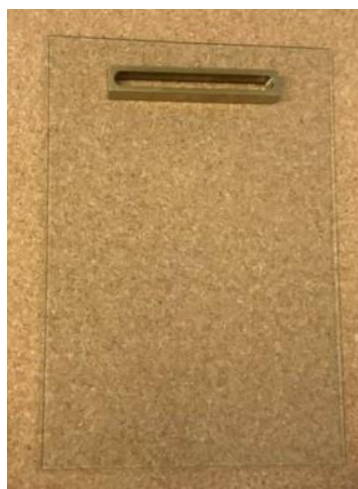
Figura 2-10. Faca colocada na extremidade da placa de vidro, pronta para iniciar a preparação das membranas.
