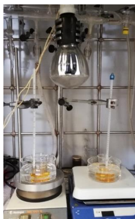
Figura 2-19. Ensaio de degradação fotocatalítica do alaranjado de metilo sob a lâmpada de 125 W.
