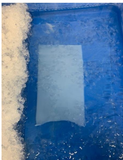
Figura 2-12. Banho de coagulação para formação das membranas, constituído por água desionizada e gelo.
