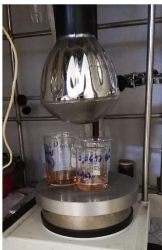
Figura 2-18. Montagem dos ensaios de degradação do alaranjado de metilo com Au_NPs.
