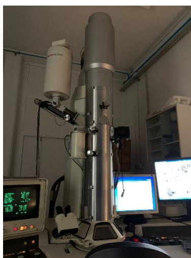
Figura 2-8. Equipamento TEM utilizado na caracterização das NPs (MicroLab, Instituto Superior Técnico, Lisboa).
