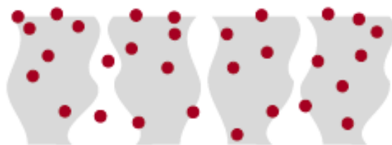
Figura 1-8. Representação esquemática de uma membrana incorporada com NPs, preparada pelo método de inversão de fases (Yin & Deng, 2015).
