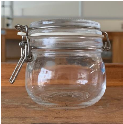
Figura 2-17. Frasco utilizado na secagem das membranas para análise em SEM.
