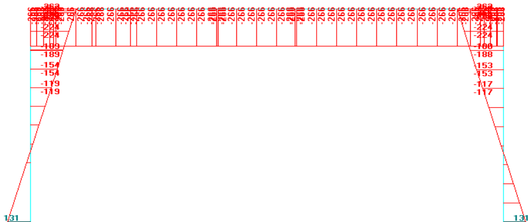
Figura 32 – Secção transversal: Diagrama de momentos flectores M (kNm/m) para a VDT sobre a laje da travessa.
