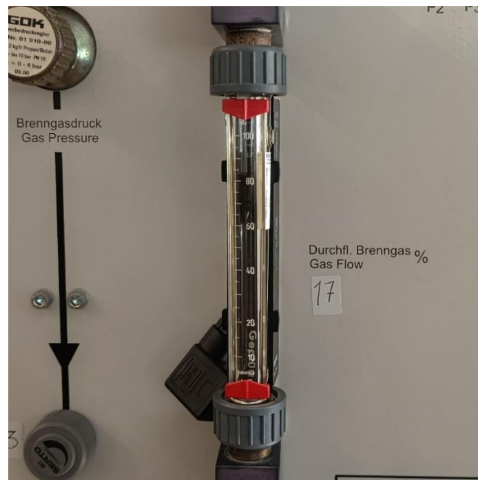
Figura 3.8 - Rotâmetro para medição do caudal das misturas de gás natural com hidrogénio.
