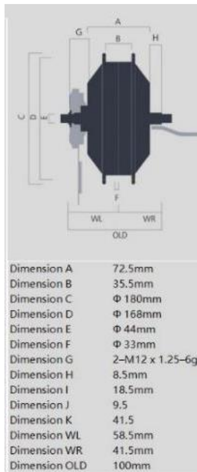
Figura 28 - Desenho de cotas do motor selecionado [Aliexpress18]
