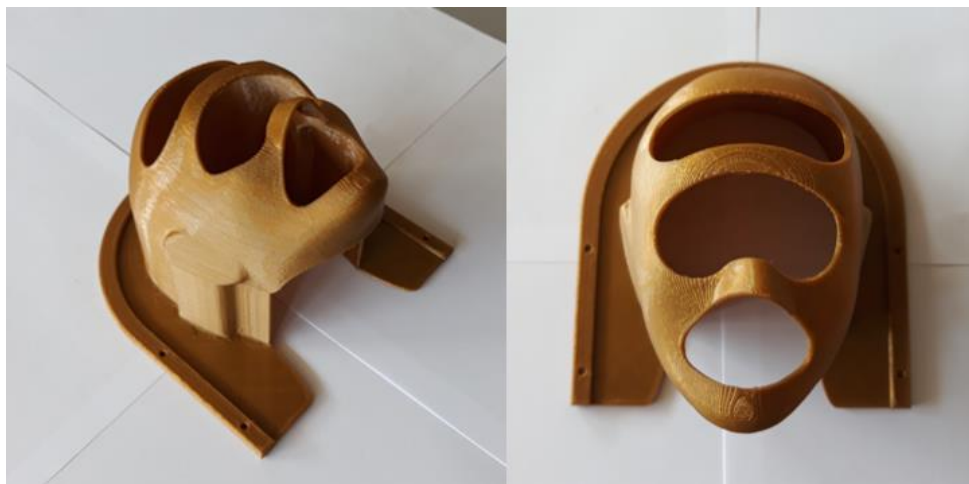
Figura 5.20. Resultados da impressão da geometria M1
