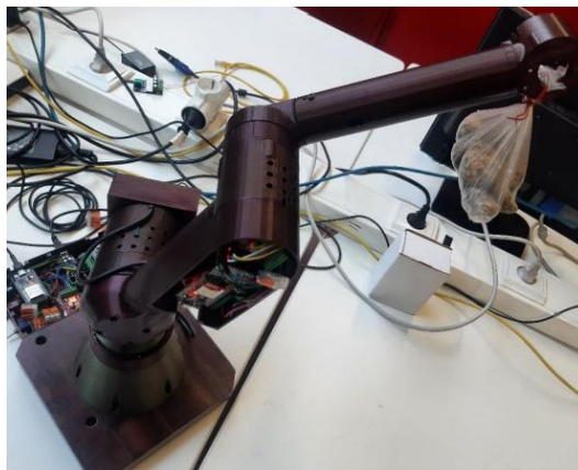
Figura 2.6 – Braço robótico colaborativo com 6-eixos, de baixo custo, desenvolvido e apresentado em Ananias (2022).
