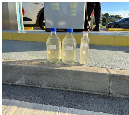
Figura 6.6 - a) O sistema de separação dos hidrocarbonetos da rodovia/ zona de abastecimento, b) amostras recolhidas no sistema de separação dos hidrocarbonetos da Rodovia/ zona de abastecimento.
