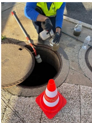
Figura 6.5 - a) O sistema de separação dos hidrocarbonetos da lavagem, b) amostras recolhidas no sistema de separação dos hidrocarbonetos da Lavagem
