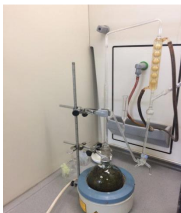
Figura 10- Esquema de hidrodestilação com um Clevenger .
