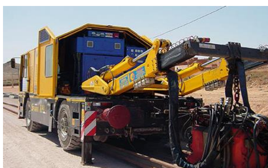
Figura 2.9 - Máquina de soldadura elétrica de carris. [6]
