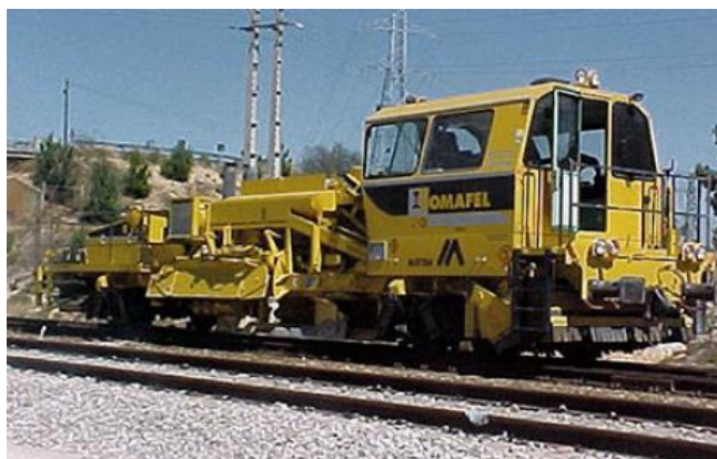
Figura 2.5 - Regularizadora de balastro com silo. [6]
