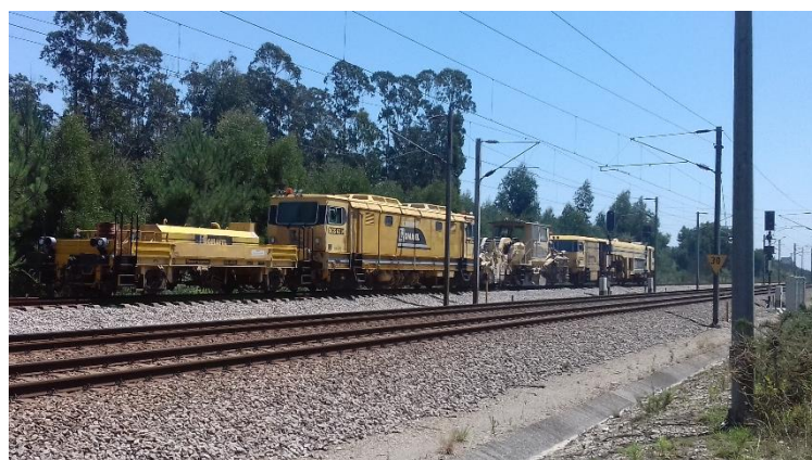
Figura 4.25 - Grupo de ataque, com Regularizadora, Atacadeira e Estabilizadora.
