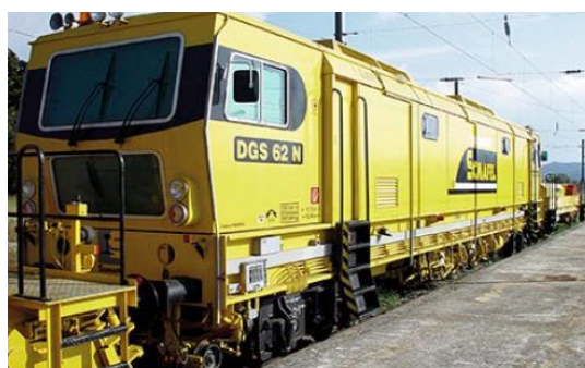
Figura 2.8 - Estabilizadora dinâmica de via. [6]
