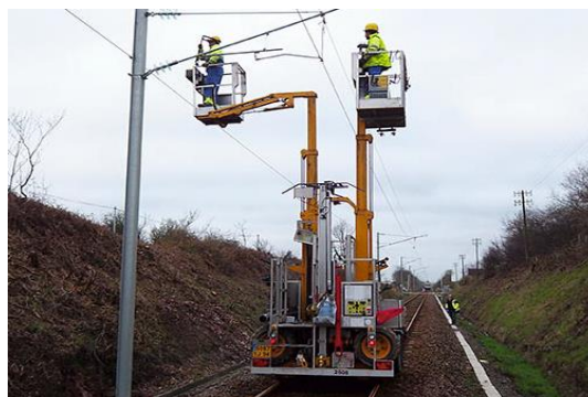
Figura 2.11 - Veículo automotriz, tipo estrada / carril. [6]
