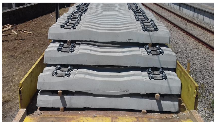
Figura 4.10 – Travessas em vagão.
