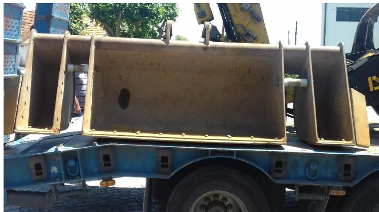
Figura 4.24 - Balde de desguarnecimento e guarnecimento.
