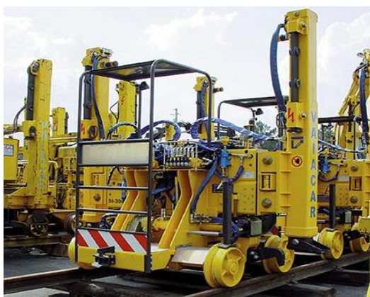
Figura 2.1 - Pórticos hidráulicos para substituição de via. [6]
