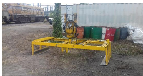
Figura 4.8 - Grade de manuseamento de travessas monobloco com aperto.
