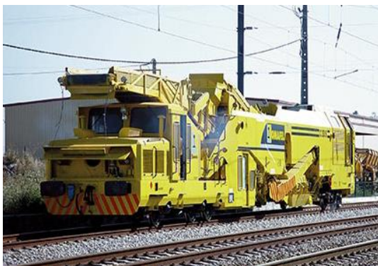
Figura 2.3 - Desguarnecedora-crivadora de balastro. [6]
