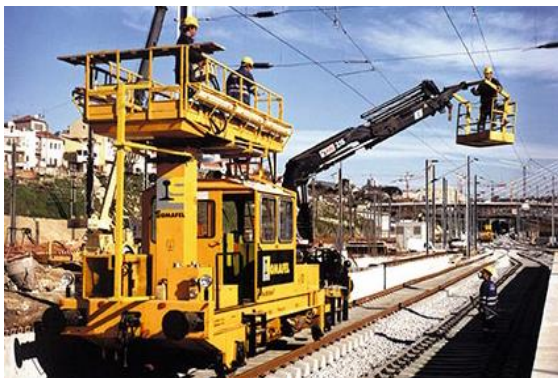
Figura 2.10 - Dresine com grua e plataforma elevatória. [6]
