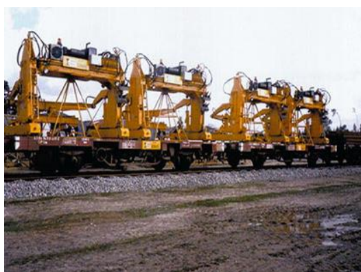
Figura 2.2 - Pórticos hidráulicos para substituição de AMV. [6]
