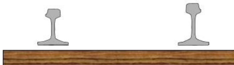
Figura 3.39 - Carril com desgaste para o exterior. [10]
