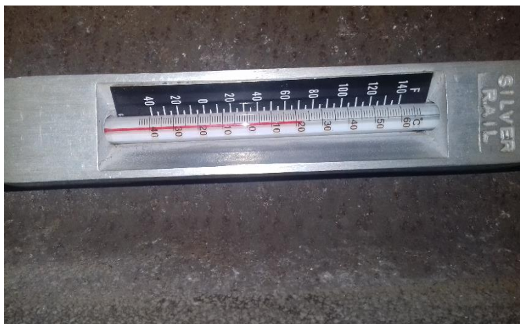
Figura 4.44 - Medição de temperatura no carril.
