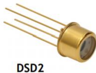
Figura 13 - Fotografia do fotodíodo DSD2 da Thorlabs[9]
