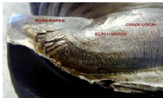
Figura 10 - Superfície de fratura do prato da cambota (Espadafor, Villanueva e García, 2009)
