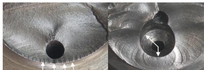
Figura 16 - Superfícies de fratura das cambotas (Fonte et al. , 2015)
