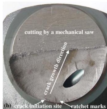
Figura 18 - Superfície de fratura do moente (Fonte et al., 2017)
