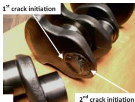
Figura 14 - Superfície de fratura antes e após reparação (Fonte et al. , 2013)
