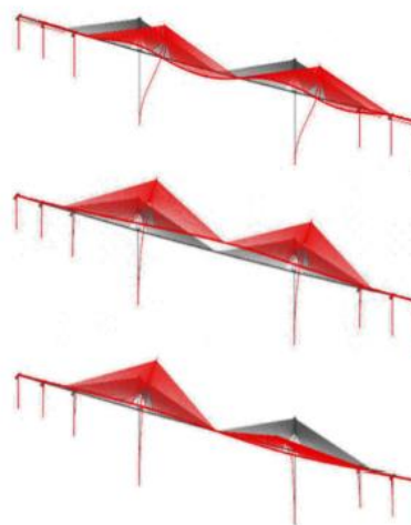
Figura 5.14 - Configurações modais de projeto dos primeiros três modos de vibração (Barata, 2012).
