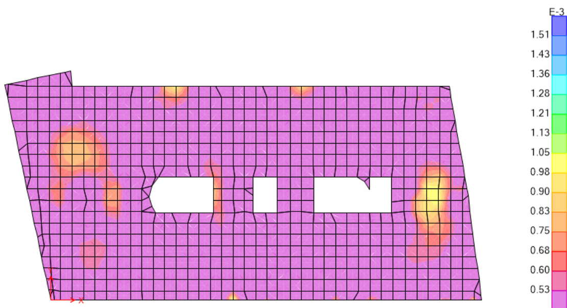
Anexo L. 33 - Área de armadura inferior na laje do piso 4 segundo a direção x em \text{m}^2/\text{m}
