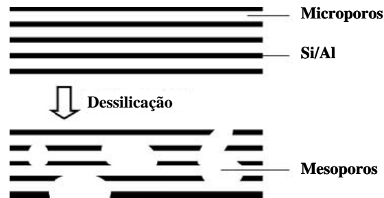
Figura 43 – Formação de mesoporos no zeólito MOR, adaptado de [54].
