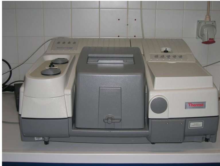
Figura 74 – Aparelho de espectroscopia de infravermelho.
