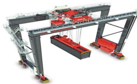
Figura 4.7 – Exemplo de RTG-E.
