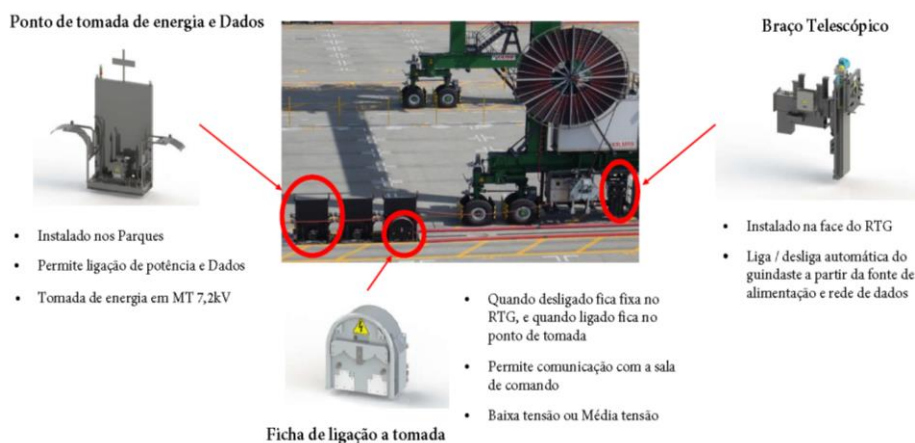
Figura nº 4.6 – Sistema de ligação automática do RTG-E [5]
