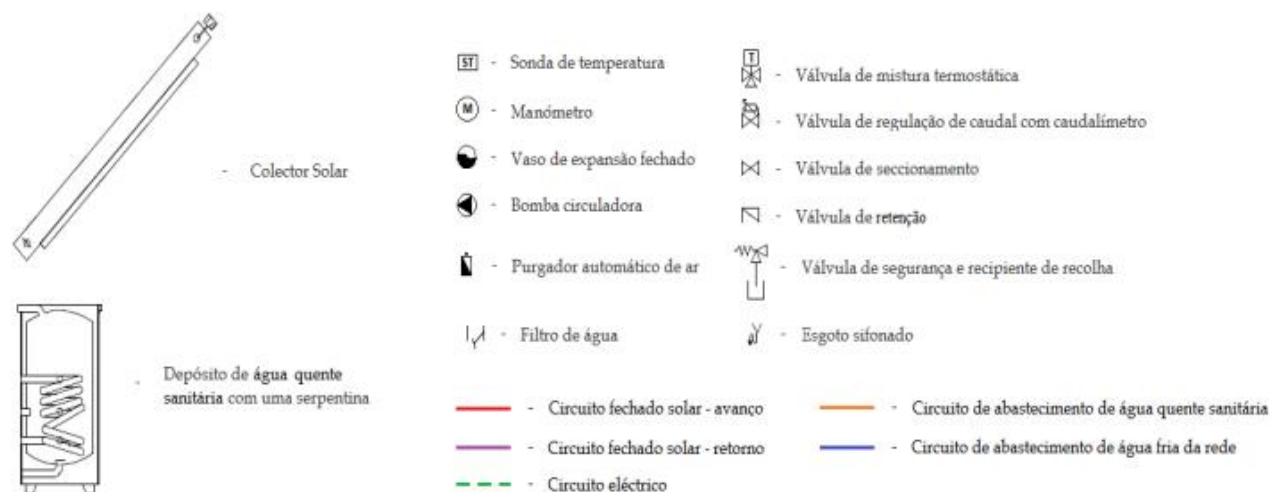
Figura 3. 16 Simbologia do esquema solar [56].
