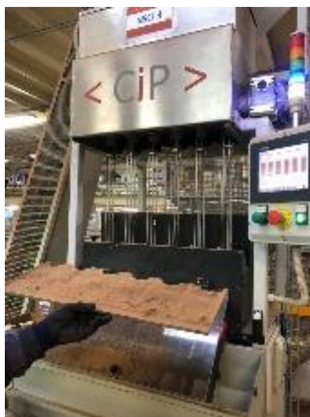
Figura 5 - Acumulação de pó
