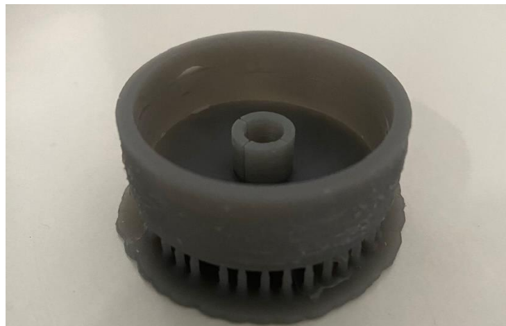
Figura 2 – Erro de impressão 3D devido à falta de suportes
