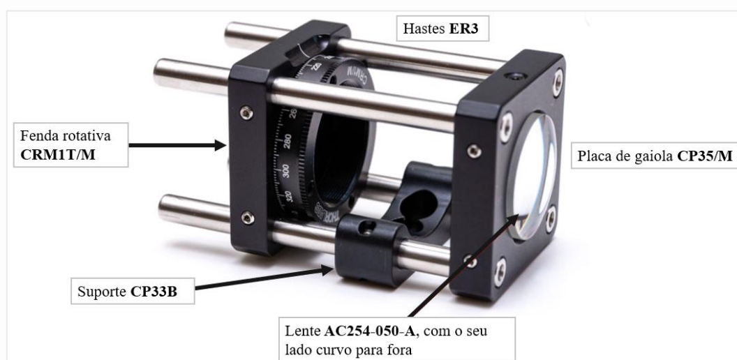
Figura 8. Componentes para a montagem do grupo de lentes e fenda, adaptado de [49].
