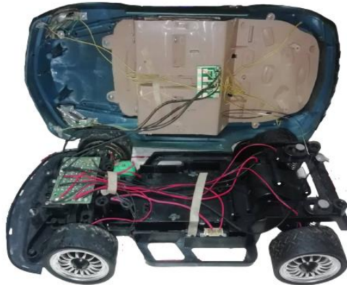
Figura 3.4 – Eletrónica presente no carro telecomandado
