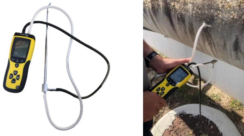
Figura 3.7 – Anemómetro de fio quente usado na medição das pressões/velocidades.
