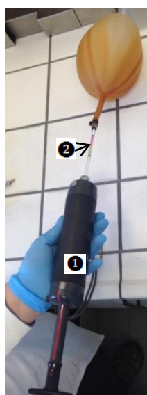
Figura 8: Equipamento para determinação de etil mercaptano no propano e butano. (1 - Bomba; 2 - tubo detetor de etil mercaptano).
