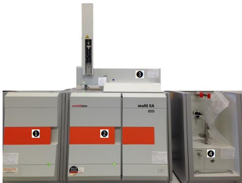
Figura 6: Equipamento existente no Laboratório da CLC para determinação do enxofre total em propano e butano (1 - Detetor UV; 2 - Forno; 3 - Amostrador Automático para Líquidos 4 - Amostrador GPL).
