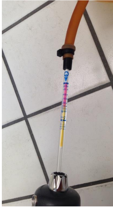
Figura 36: Modo de introdução da bexiga de orsat no tubo detetor.
