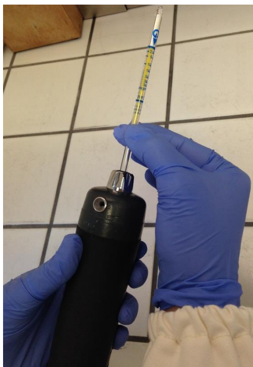
Figura 34: Introdução do tubo detetor na bomba
