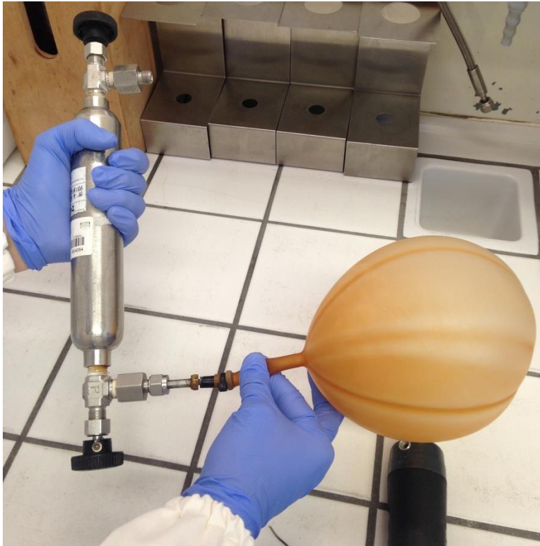
Figura 35: Enchimento da bexiga de orsat com a fase líquida da amostra.
