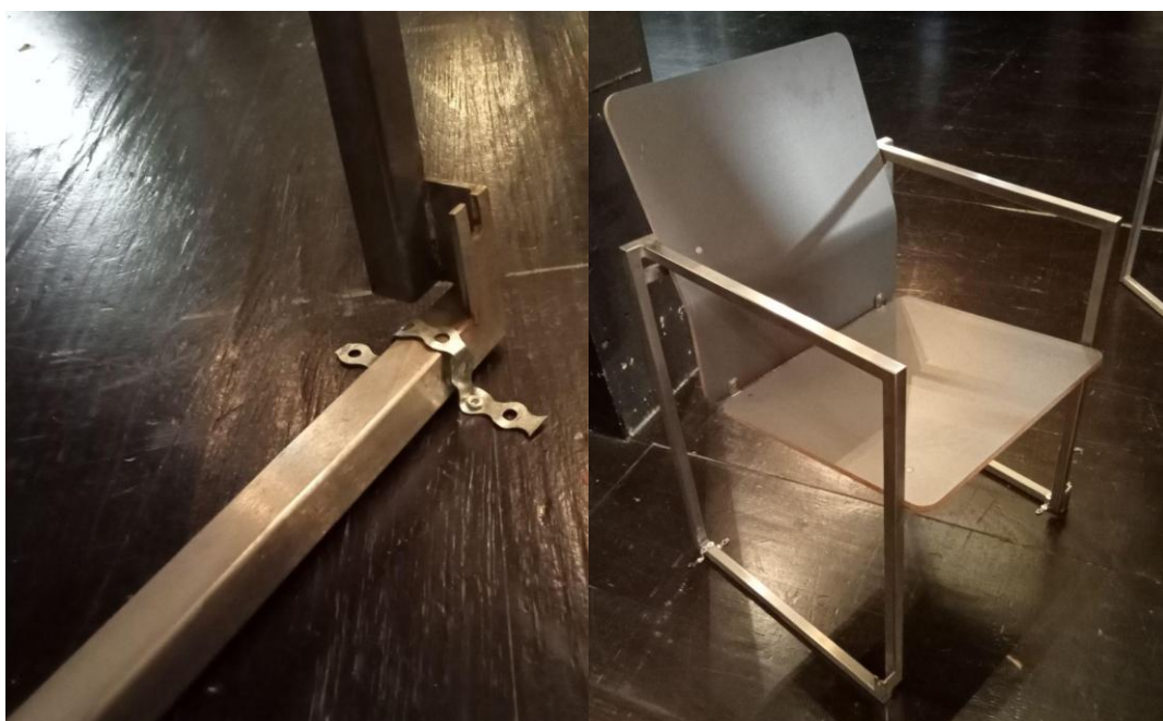
Imagem 18 - Método de fixação das cadeiras nas montagens técnicas no subpalco do SLTM, 2025.
