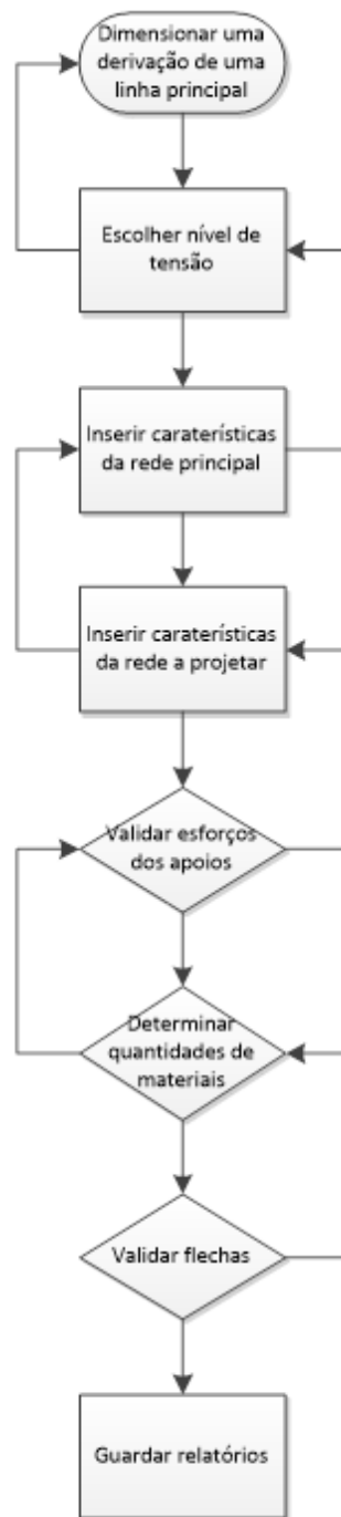
Figura 33- Validação para dimensionamento de uma derivação a partir da linha principal
