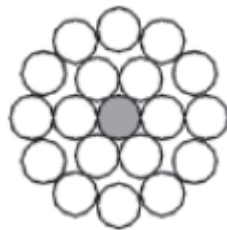
Figura 2- Seção transversal do cabo alumínio-aço [3]
