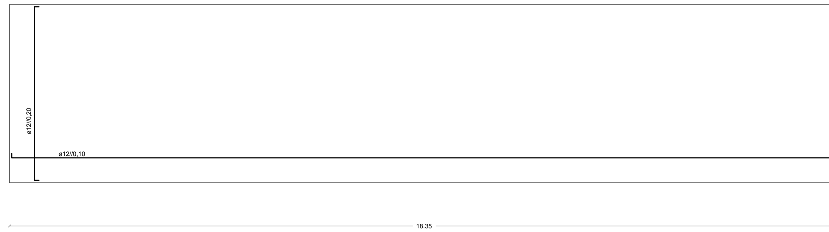
Muro 2 Armadura Exterior e Interior
