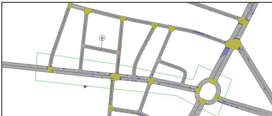
Figura 2.3 – Simulação microscópica (Simulação produzida em Aimsun)
