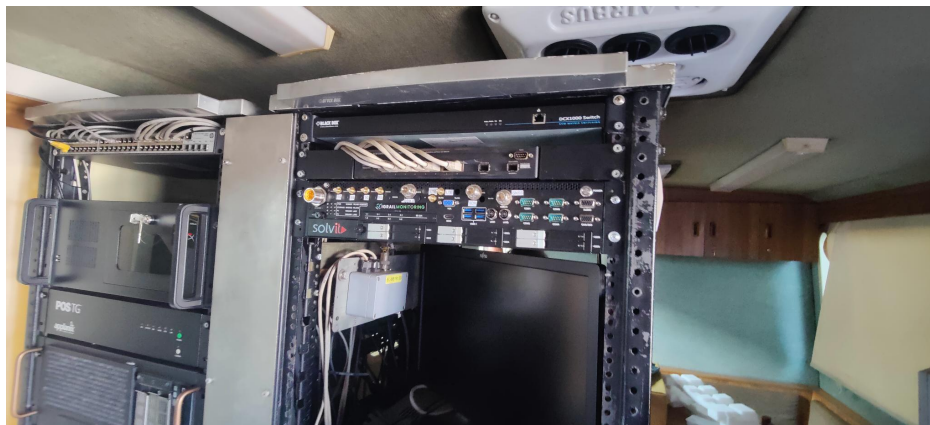
Figura 4.1: Sondas da SOLVIT instaladas nos comboios de teste.
