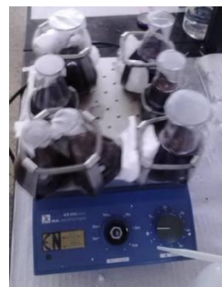
Figura 11 – Ensaios de adsorção: a) erlenmeyers com a ARI e adsorvente e b) equipamento de agitação
