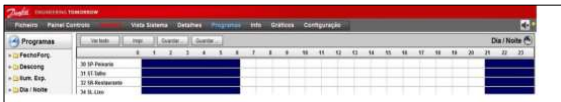
Figura 80 - Programa dia e noite para cortar a refrigeração nas salas seleccionadas, através do software store view by Danfoss
