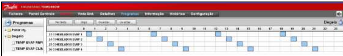
Figura 82 - Programa de descongelação para cortar a refrigeração nos evaporadores das câmaras de congelados, através do programa store view by danfoss
