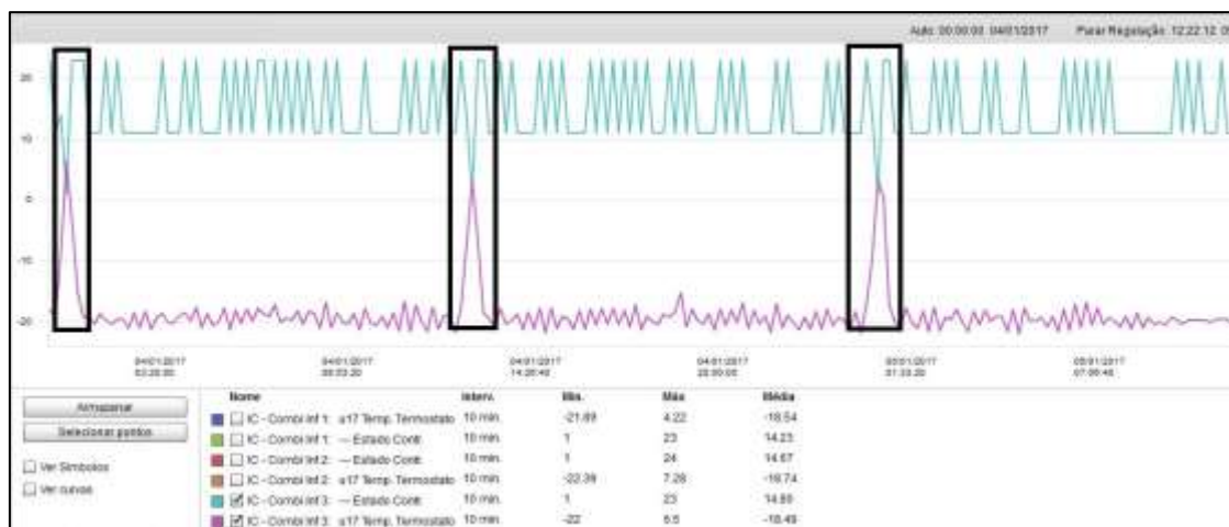
Figura 76 - Gráfico do estado do controlador e a temperatura medida no interior com indicação das descongelações de uma das três ilhas de congelados sobre controlo, através do software store view by Danfoss
