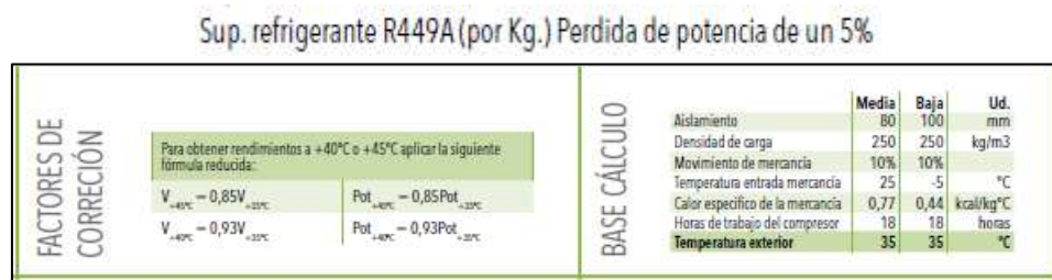
Figura 34 - Dados de cálculo utilizado para a capacidade frigorífica do monobloco (Zanotti, 2016)
