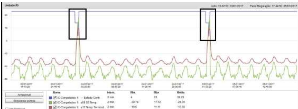
Figura 75 – Gráfico do estado do controlador e a temperatura medida no interior, com indicação das descongelações da ilha de congelados, através do software store view by Danfoss
