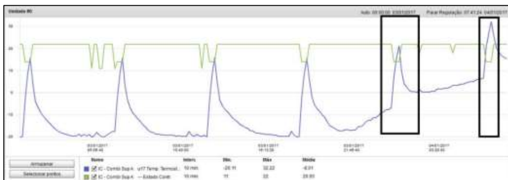
Figura 77 - Gráfico do estado do controlador e a temperatura medida no interior, com indicação de problemas na última descongelamento da ilha de congelados, através do software store view by Danfoss
