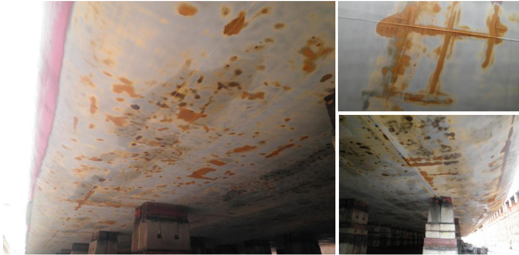
Fotografia 9 – Fundo Chato - Após lavagem 200bar da decapagem.
