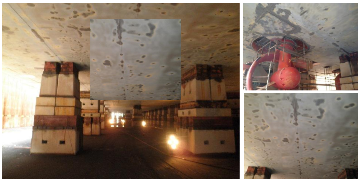
Fotografia 6 – Resultado final da decapagem no fundo do navio, Decapagem geral ao grau Sa1 com spots PSa2. [3]
