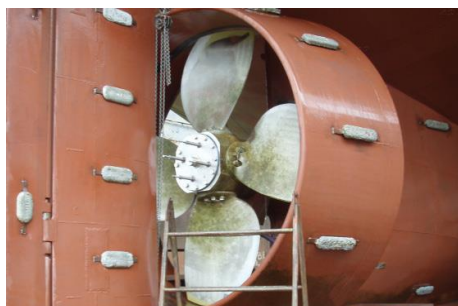
Figura 26 - Proteção Catódica através de Ânodos de sacrifício soldados aos costado de um navio. [4]
