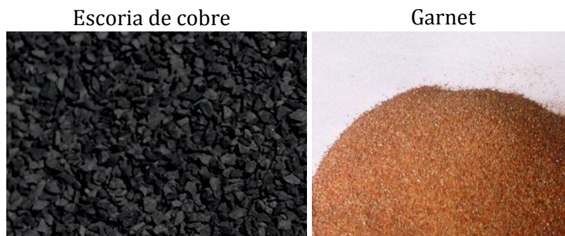
Figura 10 – Abrasivos mais usados em reparação naval. [4]
