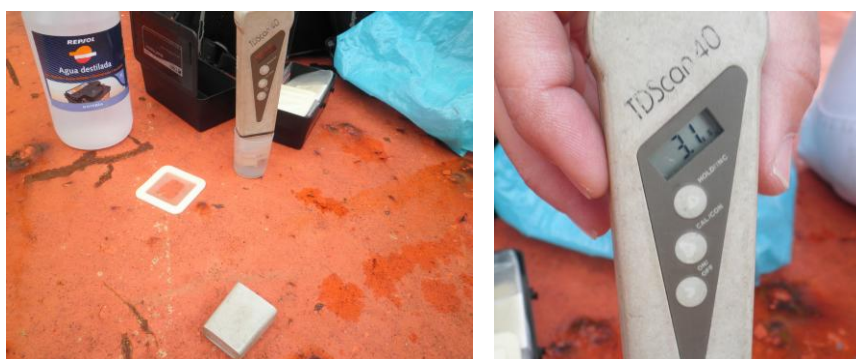
Fotografia 1 – Bresle test, teste de sais feitos para determinar a quantidade de sal existente na superfície após a lavagem. [3]
