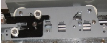
Figura 2.16: Mecanismo de suspensão do painel, com fechadura (a negro) incorporada
