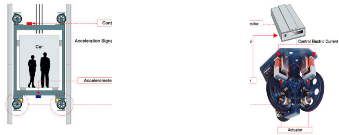
Figura 2.29: Exemplo de aplicação e pormenor de uma rodadeira activa
