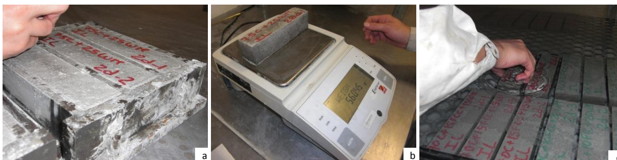
Figura 3.9 - Desmoldagem de provetes prismáticos ( 40\times 40\times 160\text{mm}^3 ). a) Identificação dos provetes de ensaio; b) Pesagem dos provetes de ensaio; c) Imersão dos provetes em água (câmara de cura).
