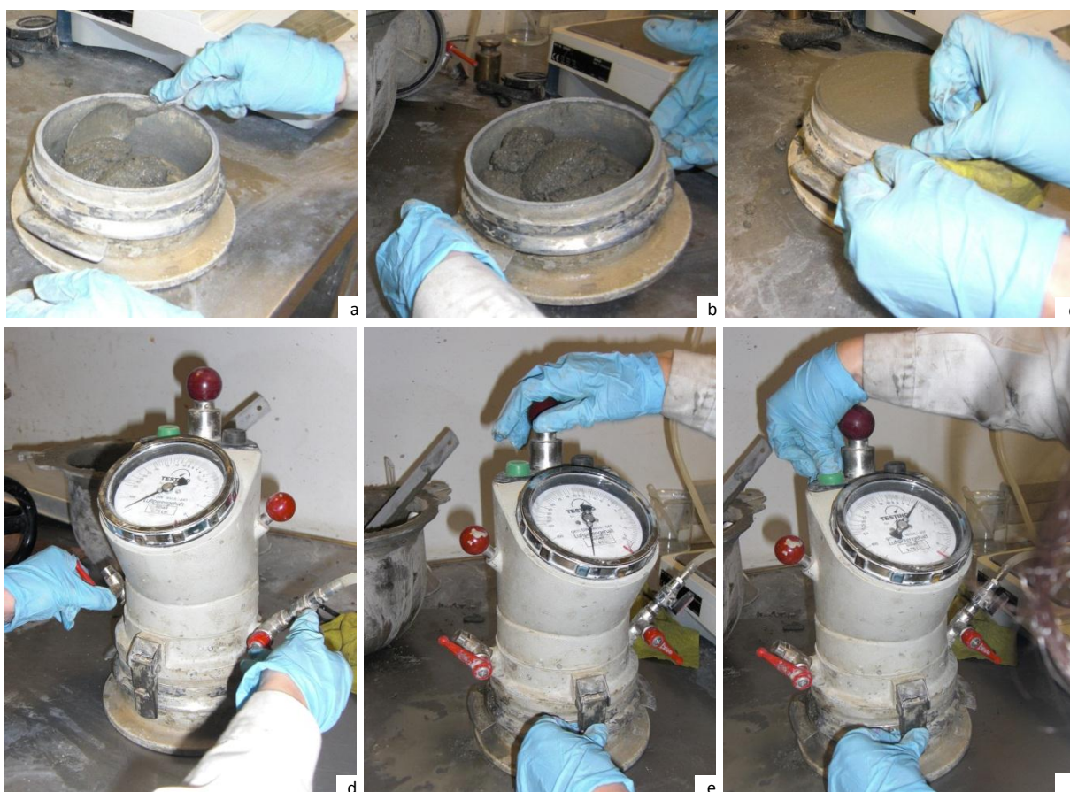
Figura 3.7 - Fases do ensaio de determinação do teor de ar (estado fresco). a) Colocação da 1ª camada de argamassa no recipiente; b) Compactação da 1ª camada de argamassa; c) Limpeza do exterior e bordos do recipiente; d) Injecção de água no aerómetro; e) Bombeamento; f) Leitura do teor de ar.
