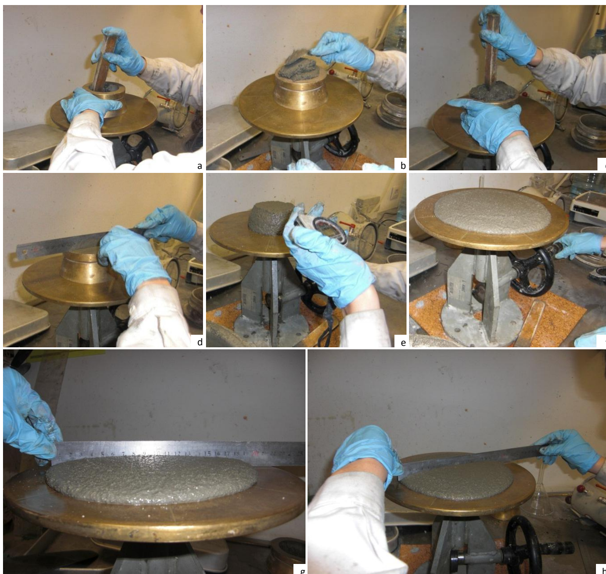
Figura 3.6 - Fases do ensaio de consistência por espalhamento (estado fresco). a) Compactação com pilão de madeira da 1ªcamada; b) Emprego da 2ª camada de argamassa; c) Compactação com pilão de madeira da 2ªcamada; d) Regularização da superfície; e) Levantamento do molde tronco-cónico; f) Espalhamento da argamassa na mesa de espalhamento, após 15 pancadas; g) Medição do espalhamento da argamassa (direcção 1); h) Medição do espalhamento da argamassa (direcção 2).
