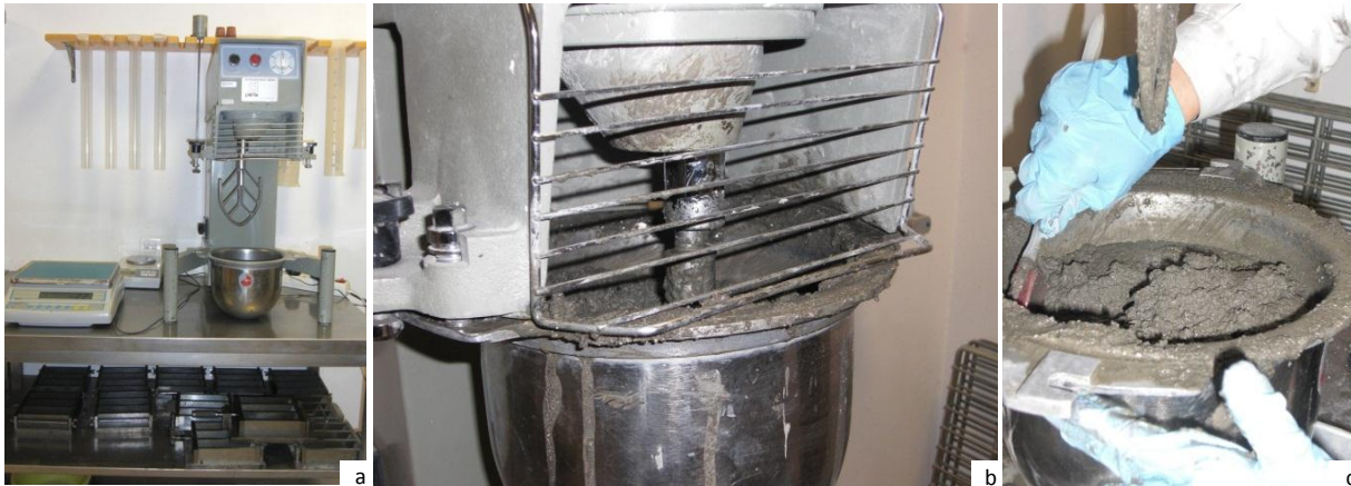
Figura 3.5 - Fases de preparação de argamassa. a) Misturadora mecânica; b) Misturadora em funcionamento ( v_1 ); c) Recolha da argamassa aderente às paredes e fundo da cuba.
