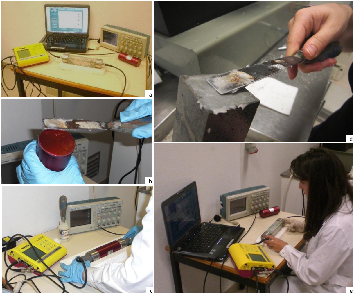
Figura 3.10 - Fases do ensaio determinação da velocidade de propagação de ondas ultra-sónicas (estado endurecido). a) Montagem e ligação do sistema; b) Aplicação de camada de vaselina no cilindro de referência; c) Calibração do aparelho (cilindro de referência); d) Aplicação de camada de vaselina no provete ensaiado; e) Determinação da velocidade de propagação de ondas ultra-sónicas.
