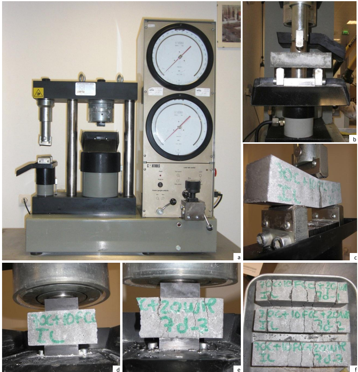
Figura 3.11 - Fases do ensaio determinação da resistência mecânica (estado endurecido). a) Máquina de ensaios de resistência mecânica; b) Posicionamento do prisma na máquina de resistência à flexão; c) Accionamento do dispositivo de carga para determinação da resistência à flexão; d) Posicionamento do prisma na máquina de resistência à compressão; e) Accionamento do dispositivo de carga para determinação da resistência à compressão; f) Provetes após ensaio.
