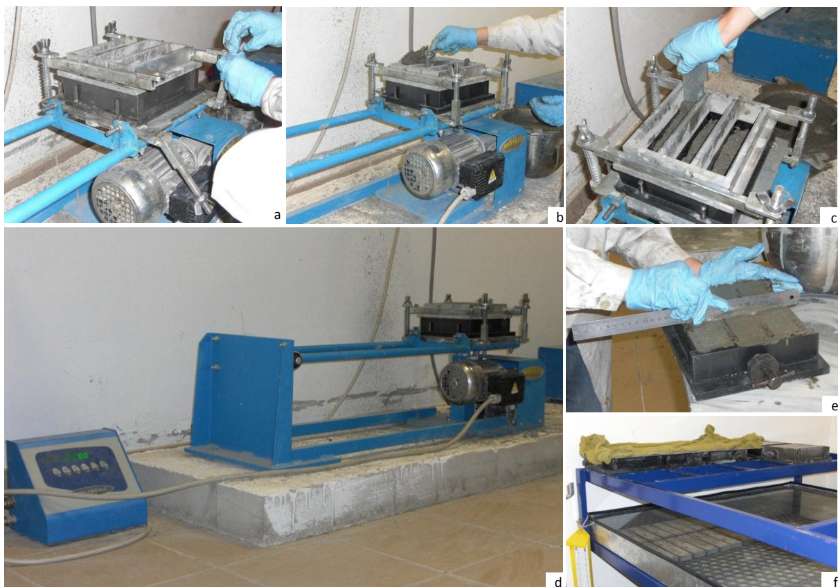
Figura 3.8 - Moldagem e condicionamento de provetes prismáticos ( 40 \times 40 \times 160 \text{ mm}^3 ). a) Posicionamento do molde na mesa de compactação; b) Introdução da 1ª camada de argamassa no molde; c) Distribuição uniforme da 1ª camada de argamassa; d) Mesa de compactação mecânica; e) Regularização da superfície; f) Moldes na câmara de cura.
