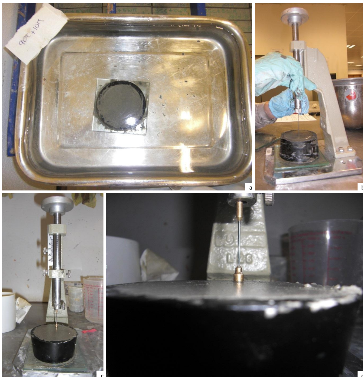
Figura 3.4 - Fases de determinação dos tempos – início e fim – de presa (estado fresco). a) Molde e placa imersos no recipiente; b) Ajuste da agulha de determinação do início de presa no aparelho de Vicat; c) Determinação do tempo de fim de presa; d) Detecção visual do fim de presa.
