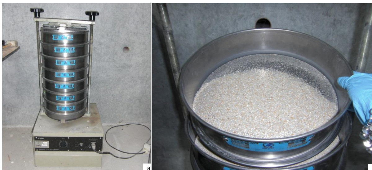
Figura 3.2 - Separação granulométrica (peneiração mecânica). a) Série de peneiros de malha quadrada; b) Resíduo de areia (AS 30/40) acumulado (na malha 0,5 mm).
