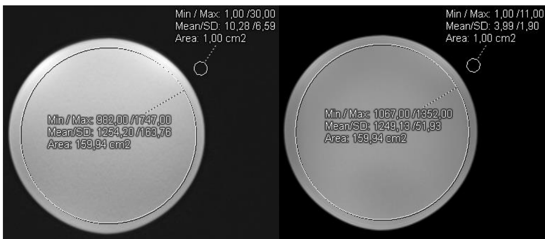
Figura 4.14 – Delimitação das ROI em fantoma, na técnica HASTE (à esquerda) e em T2 TSE (à direita), para cálculo da SNR. Imagem original deste estudo, com recurso ao software Syngo.via.
