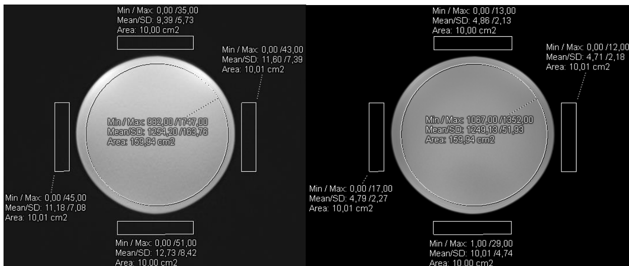
Figura 4.16 - Delimitação das ROI em fantoma, na técnica HASTE (à esquerda) e em T2 TSE (à direita), para cálculo do Rácio de Artefacto Fantasma. Imagem original deste estudo, com recurso ao software Syngo.via
