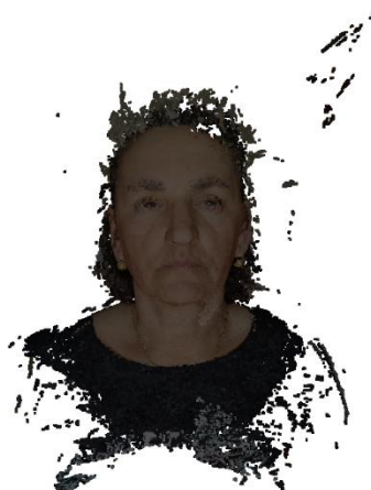
Figura 3.42 – Nuvem de pontos por fotogrametria no Meshlab.
