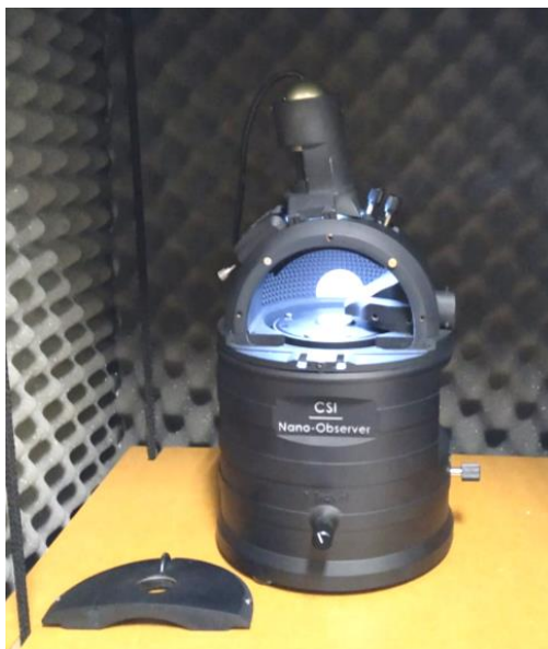
Figura 3.7 - Microscópio de força atômica utilizado na aquisição de imagens da superfície do sensor piezoelétrico. Retirado de Pereira, 2019.
