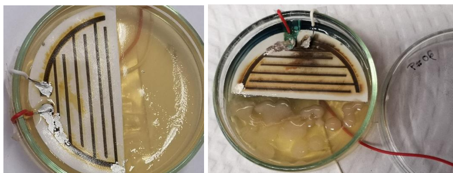
Figura 56 - Circuito impresso com tinta de prata em papel de filtro, P#06.
