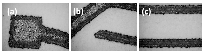
Figura 47 - Fotografias do circuito P#02 visualizado a microscópio ótico.
