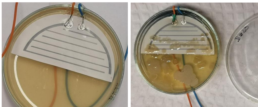
Figura 60 - Circuito impresso com tinta PEDOT:PSS em papel de filtro, B#20.
