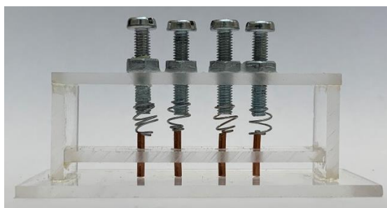
Figura 14 - Método de medição de corrente com quatro pontos utilizado.
