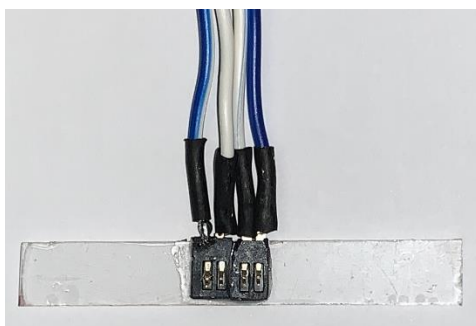
Figura 16 – Dispositivo em pormenor utilizado na medição com quatro pontos.
