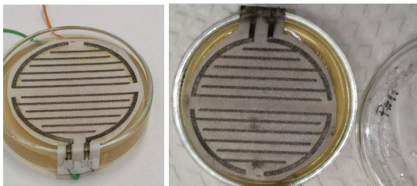
Figura 55 - Circuito impresso com tinta de prata em papel de impressão, P#11.
