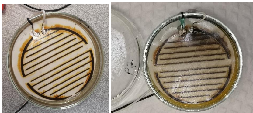
Figura 54 - Circuito impresso com tinta de prata em papel de filtro, P#07.
