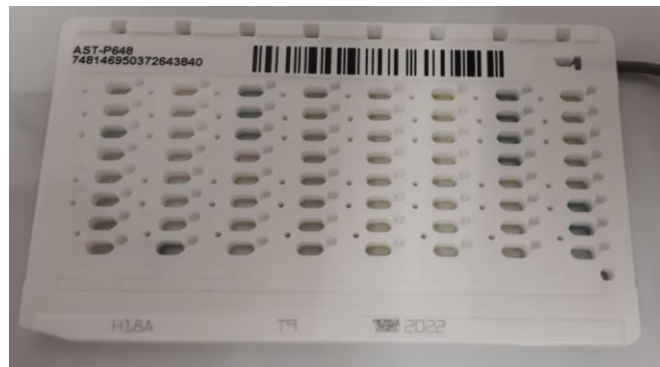
Figura 4.7 - Carta P-648 utilizada para teste de sensibilidade a antibióticos (VITEK2). Fotografia captada durante o projeto.
