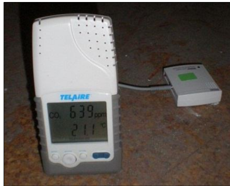
Figura 2 - Analisador de gás. Aparelho de monitorização e registo da concentração utilizado nos ensaios de gás traçador.
