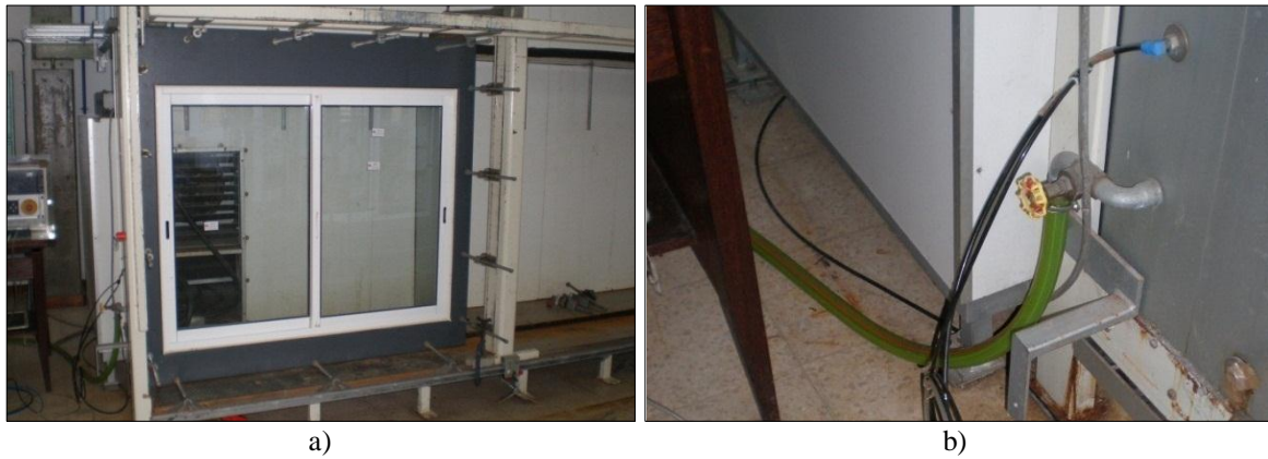
Figura B.3 – Calibração das células de pressão. a) Câmara de ensaios de permeabilidade ao ar de caixilharia, LNEC. b) Ligação de um terminal da célula de pressão ao interior da câmara.
