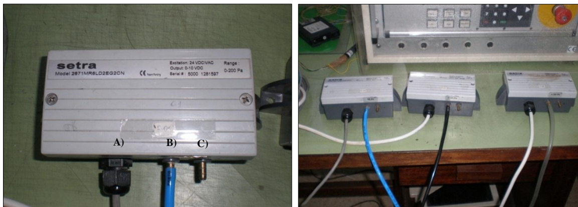
Figura B.2 – Células de pressão. A) Ligação ao logger , transmissão da tensão eléctrica gerada pela sonda. B) Terminal com ligação ao interior da câmara. C) Terminal com ligação ao exterior da câmara (referência).
