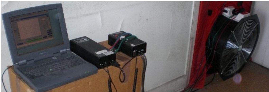
Figura 1 – Imagem geral do equipamento utilizado no ensaio de pressurização.
