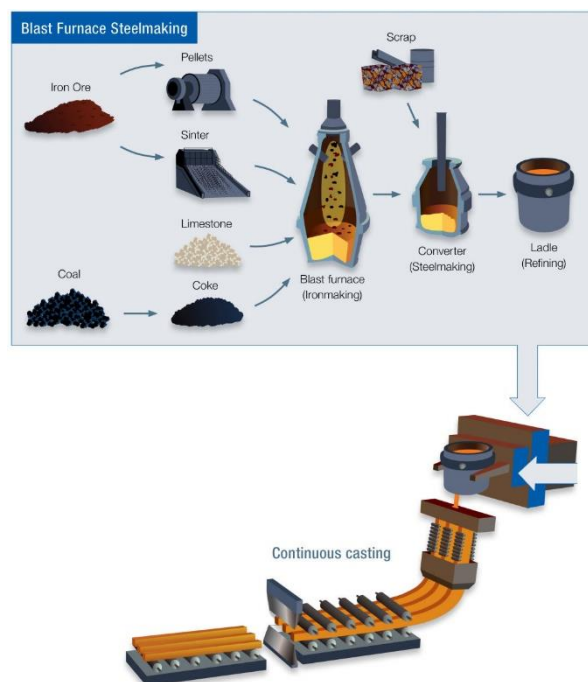
Figura 2.1 – Processo produtivo com recurso ao Alto Forno (EUROFER, 2020).
