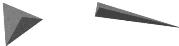
Figura 46: elementos tetraédricos regulares vs irregulares
