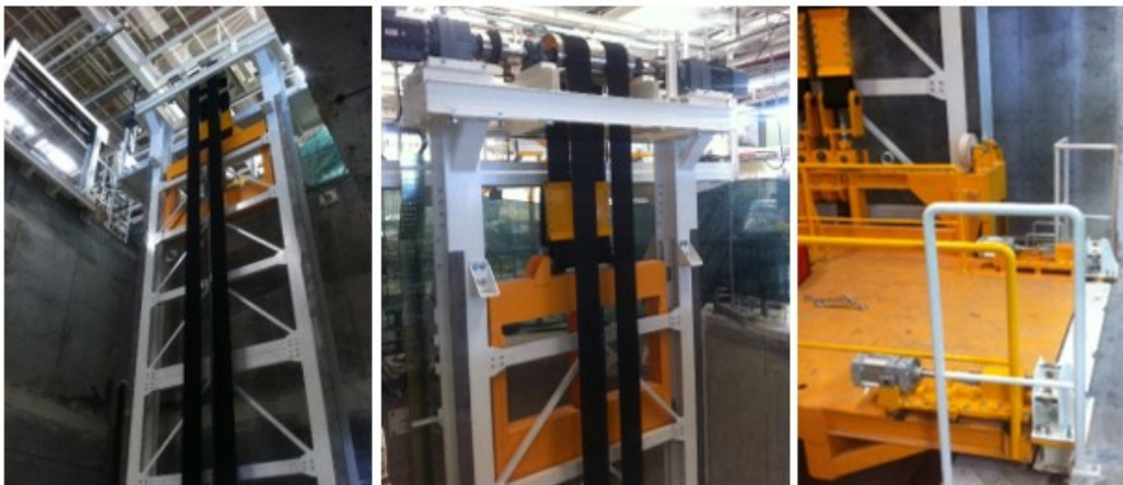
Figura 1: Montagem real da Plataforma Elevatória
