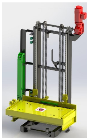
Figura 13: Elevador de corrente para elevação de palete [4]
