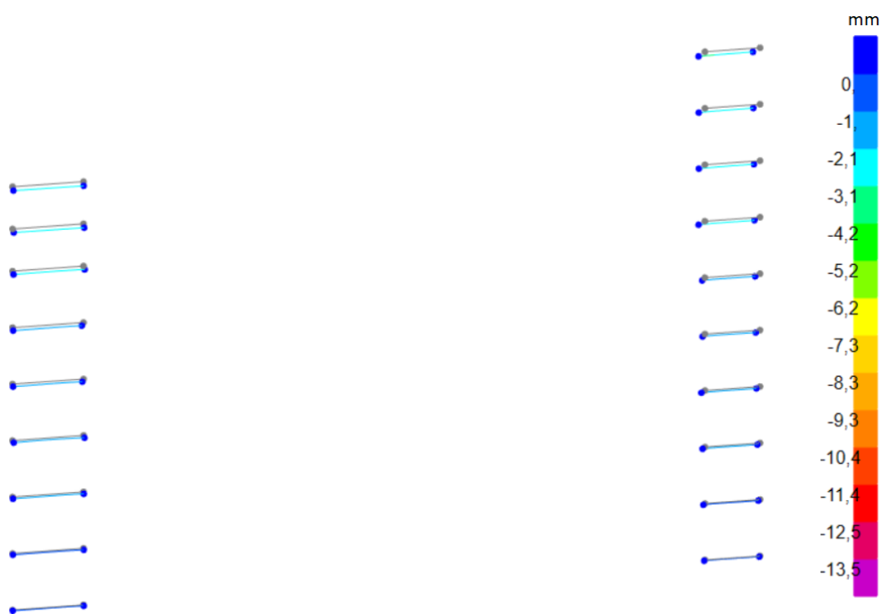
Figura 9.95 Flechas máximas verticais devido à combinação condicionante.
