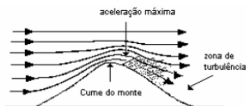
Figura 3.1 – Aceleração do vento sobre uma elevação
