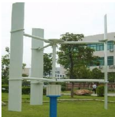
Figuras 2.19 e 2.20 – Ciclo-turbina de Darrieus
