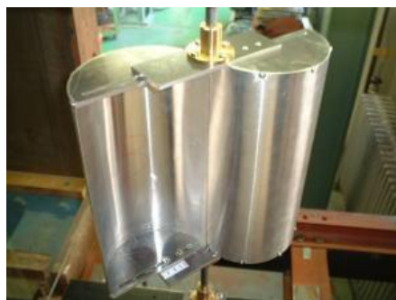
Figura 2.24 – Exemplo de turbina eólico de Savonius em construção
