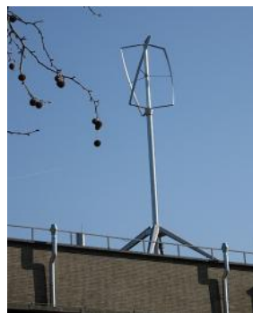
Figura 2.21 e 2.22 – Turbinas de Darrieus com asas helicoidais
