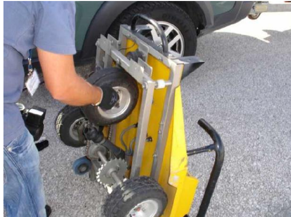
Figura 3.15 – Verificação prévia do GripTester [Romão, 2010]
