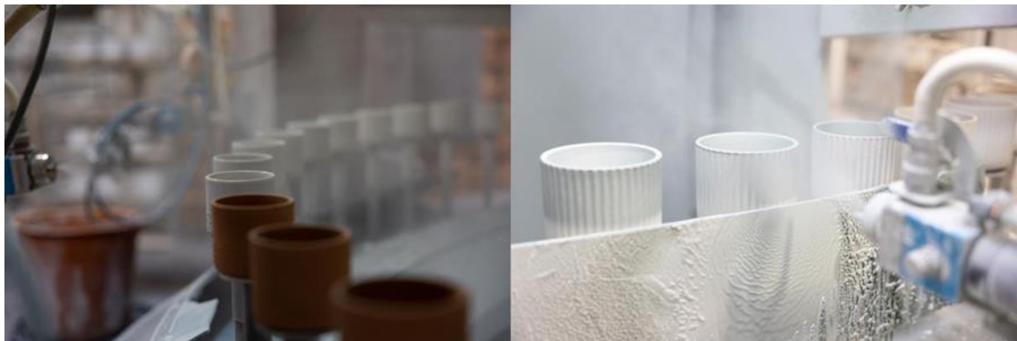
Figura 3.8 - Processo de vidragem na R&C Containers
