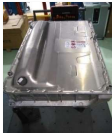
Figura 11 – Bateria 8,7 kWh VW Golf GTE PHEV (Centro técnico VW)
