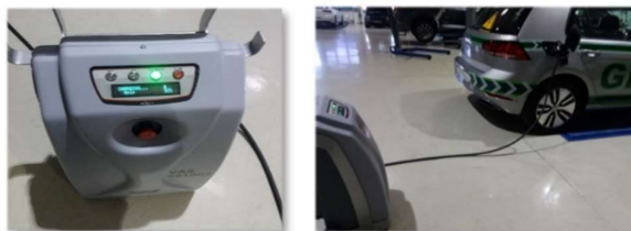
Figura 49 e 50 – PC Rápido 20 kW ies VAS 681 003 e ligação ao E-Golf
